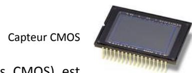
Le capteur photo CCD - pour Charge Coupled Device - (ou parfois CMOS) est composé d'un grand nombre de **photosites** (quelques dizaines de millions), chaque photosite va recevoir de la lumière, l'intensité lumineuse va être "convertie" en tension électrique. Plus l'intensité lumineuse reçue par le photosite est importante plus le photosite produira une tension électrique importante (et ce quelle que soit la couleur de la lumière incidente).
